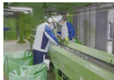
破砕鉄手選別コンベヤ 磁選機から送られてきた破砕鉄に混ざった異物を人手により取り除きます。
