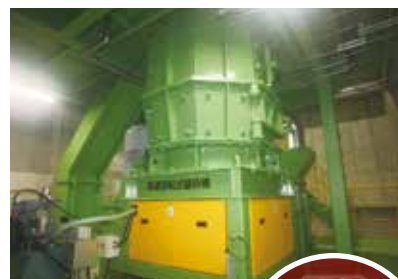
高速回転式破砕機 低速回転式破砕機で破砕処理されたごみを約15cm以下に破砕します。
