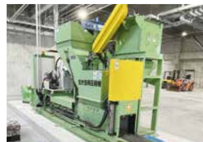
空き缶用圧縮機 人手により異物を除去した上で、選別機により選別されたスチール・アルミを圧縮成型します。
