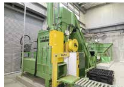
ペットボトル圧縮梱包機 人手によりキャップ・ラベルを外し、異物を除去したペットボトルを圧縮してPPバンドにより梱包します。
