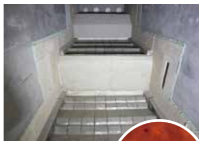
焼却炉 850℃以上の高温で焼却を行い、ダイオキシン類などの有害物質の発生を抑制します。
