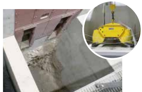
灰ピット・灰クレーン 焼却炉から出た焼却灰と、飛灰処理物を灰クレーンで灰トラックに積み込みます。
